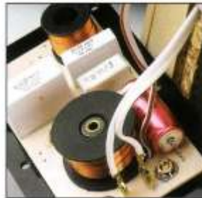
Die Frequenzweiche ist sauber bestückt und kommt mit sechs Bauteilen aus.
